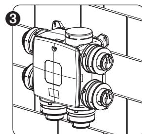
Die Lüftereinheit über die 4 vormontierten Schrauben montieren. Darauf achten, dass das Abluftrohr in Richtung zum Dachabzug angebracht wird!
