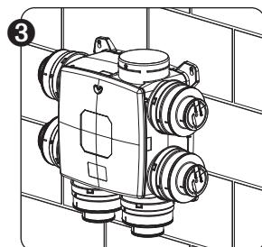
Conecte el sistema de ventilación sobre los 4 tornillos. Cerciorarse que la salida de aire de la unidad está colocado hacia el techo / pared de salida.
