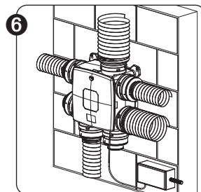
Dévissez le couvercle du boîtier du ventilateur. Débranchez l'alimentation ! Veillez à ce que le courant soit coupé. Raccordez le câble pour l'interrupteur à 3 positions selon le schéma de câblage (section 6.1).
