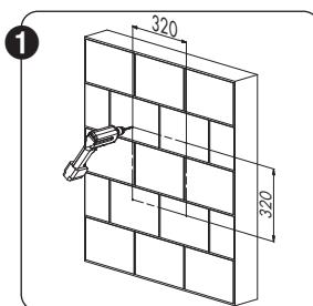
Die Bodenplatte der Cbase® an die Wand anlegen und die Schraubenlöcher markieren (die Wand muss mindestens 100 kg Masse/m<sup>2</sup> aufweisen, um eine Geräuschübertragung zu vermeiden).
