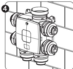
Plaats het aantal gewenste aansluitdoppen op de ventilatorenheid en snij ze af op de gewenste diameter ( $\varnothing 80$  mm /  $\varnothing 125$  mm). Sluit de andere aanzuigpunten af met de bijgeleverde stoppen.
