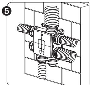
Raccordez les conduits aux bouchons/réductions. Utilisez les colliers de serrage.
