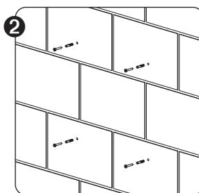
Montez les chevilles et les vis (adaptées au type de surface) sur le mur. Veillez à ce que la tête de la vis dépasse de  $\pm 7 \text{ mm}$ .
