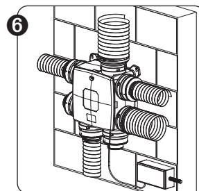
Desenrosque la tapa de la caja de ventilación. ¡Cerciorarse que la alimentación está apagada!. Conectar el cable de alimentación y el cable para el interruptor de tres posiciones de acuerdo al esquema de cableado eléctrico (sección 6.1).
