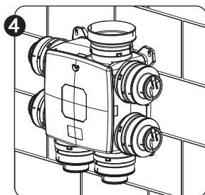
Poner el número de adaptadores en el sistema de ventilación y cortarlos para abrir el diámetro deseado ( $\varnothing 80$  mm /  $\varnothing 125$  mm). Cerrar los otros puntos de extracción de la unidad con las tapas de cierre.
