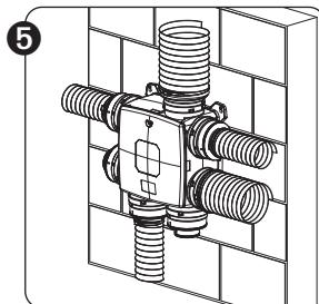
Sluit het kanaalwerk aan op de aansluitstukken. Gebruik hiervoor spanbanden.
