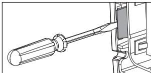
Hierna kan de motorunit uit de behuizing genomen worden. Raak de elektronica binnenvin niet aan!
