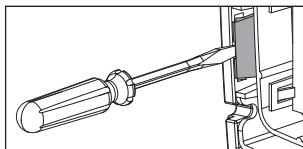
Danach kann die Motoreinheit aus dem Gehäuse genommen werden.
