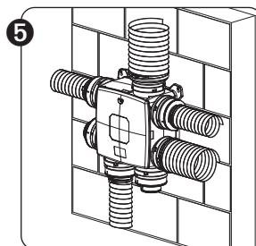
Conectar los conductos de ventilación a las adaptadores por medio de fijación de correas.
