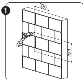
Colocar la base de montaje del Cbase® contra la pared y, transferir con un lápiz la posición de la orificios de los tornillos a la pared (la pared tiene que tener una masa mínima de 100 Kg/m<sup>2</sup> para evitar la transferencia de ruido).
