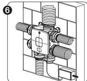
Schroef de afdekplaat van de ventilatorbehuizing los. Voeding uit! Zorg ervoor dat de netvoeding uitgeschakeld is. sluit de aansluitingskabel voor de 3 standenschakelaar en de voedingskabel aan volgens het aansluitschema (sectie 6.1)
