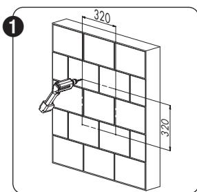
Placez la plaque de base de Cbase® contre le mur et marquez les trous de vis (le mur doit avoir une masse minimale de  $100 \text{ kg/m}^2$  pour éviter la transmission de bruit).
