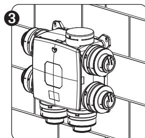
Haak de ventilatoreenheid over de 4 voorgemonteerde schroeven. Let er op dat de afblaas in de richting van de dakafvoer geplaatst wordt!
