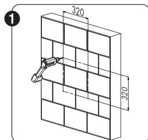
Plaats de bodemplaat van de Cbase® tegen de wand en teken de schroefgaten af (wand moet een minimale massa van 100 kg/m<sup>2</sup> hebben om geluidsoverdracht te vermijden).
