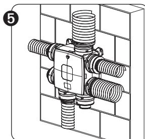
Die Rohrleitungen an die Anschlusselemente anschließen. Dazu die Spannbänder benutzen.
