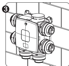
Suspendez l'unité de ventilation aux vis prémontées. Veillez à ce que la bouche d'expulsion soit placée dans la direction de la sortie en toiture !
