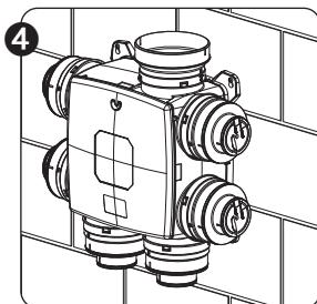
Placez les bouchons/réductions sur l'unité de ventilation et coupez-les au diamètre voulu ( $\varnothing 80$  mm /  $\varnothing 125$  mm). Fermez les autres points d'extraction au moyen des couvercles fournis.
