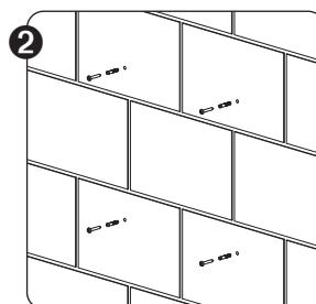
Wanddübel anbringen und an die Wand (passend zum Untergrund) anschrauben. Dafür sorgen, dass der Schraubenkopf um ± 7 mm herausragt.
