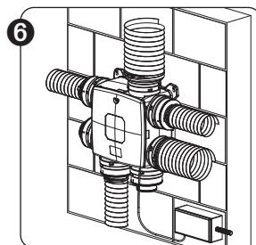
Die Abdeckplatte vom Lüftergehäuse lösen.
