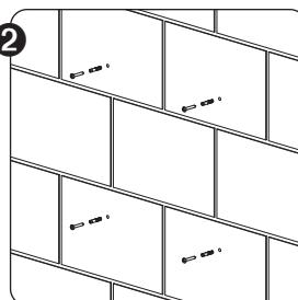
Fijar los tacos y tornillos de montaje en la pared (adecuados para el tipo de superficie). Cerciorarse que las cabezas de los tornillos sobresalen ± 7 mm.
